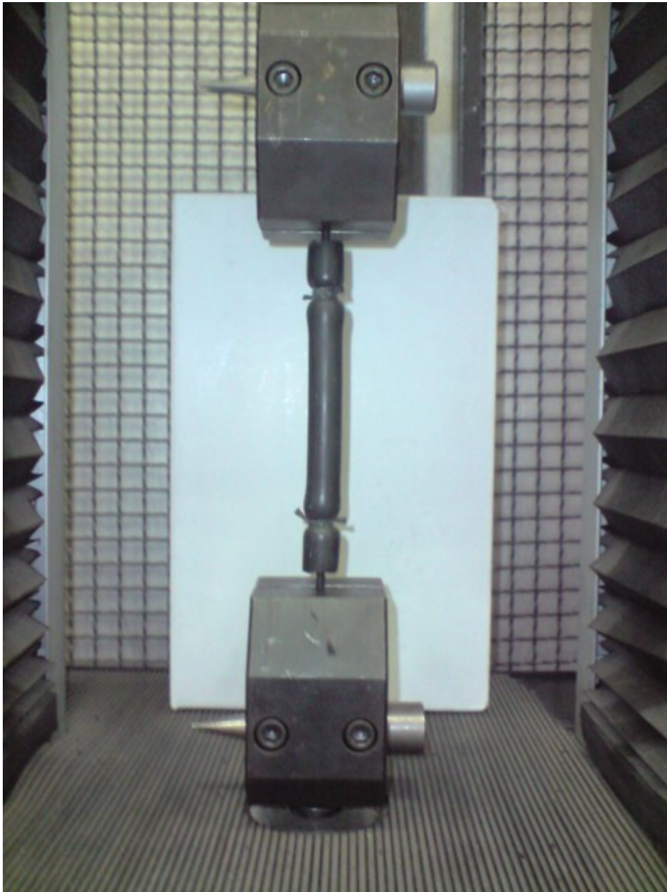
L'elastico fissato al macchinario viene portato all'allungamento previsto
